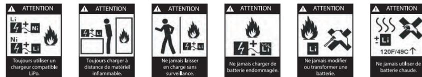
ATTENTION: Toutes les précautions d'utilisation concernant les batteries LiPo doivent être suivies rigoureusement. Une mauvaise manipulation de la batterie peut provoquer un incendie, une explosion, des blessures personnelles ou des dégâts matériels.
