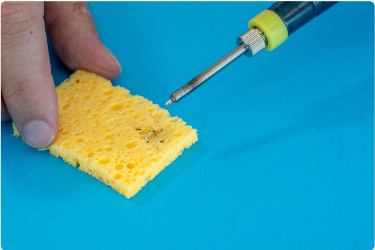
Nettoyage de la pointe du fer à souder
