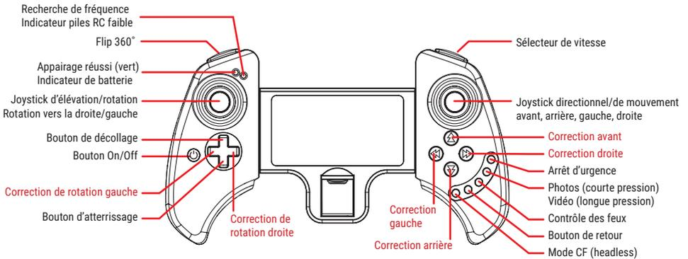
\*Les fonctions en rouge ci-dessus permettent de rééquilibrer le drone en ajustant la puissance délivrée par chacun des moteurs (Page 12).
