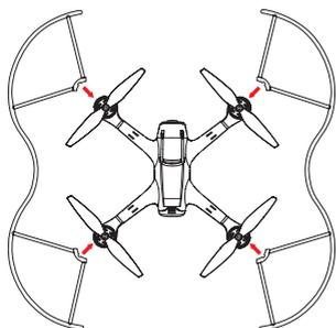
Figure 4: Installation des protections d'hélices
