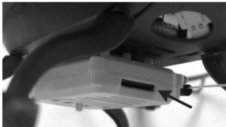
1/ Installez la caméra sur la base en-dessous du drone en insérant les pieds de la caméra dans les encoches prévues à cet effet. Poussez doucement jusqu'au bout pour fixer solidement la caméra. Assurez-vous que la lentille de la caméra soit orientée vers l'avant du drone.
