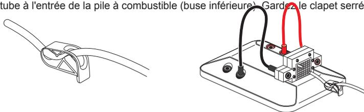
b. Utilisez les câbles noir & rouge afin de raccorder le module ventilateur au module pile à combustible. Assurez-vous de respecter le code couleur lorsque vous branchez chaque câble dans la prise correspondante.
