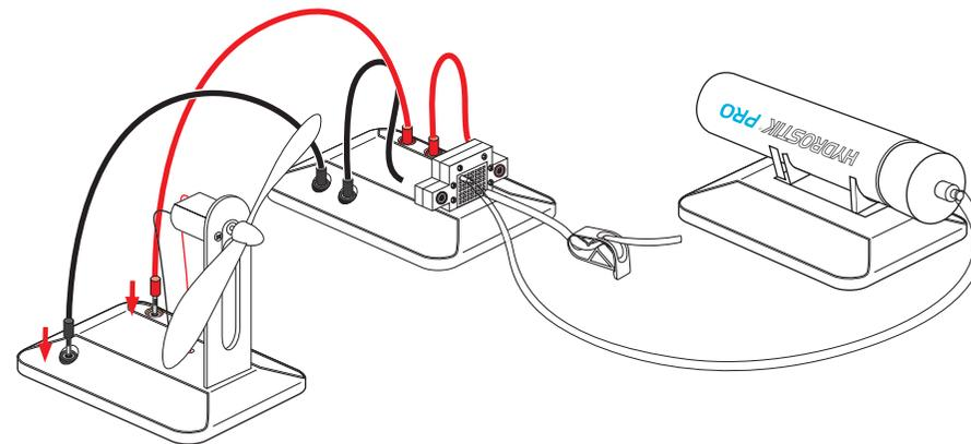
Vous pouvez à présent mesurer la tension & le courant de sortie générés par la pile à combustible au moyen d'un multimètre ou du Moniteur Énergie Horizon (réf. produit FCJJ-24), ou réaliser diverses expériences.
