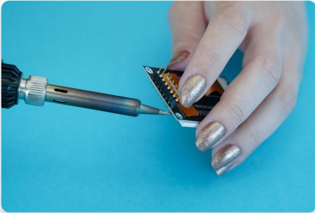
**3) Si la tête est légèrement de travers et doit être ajustée, faites fondre la soudure et inclinez les têtes avec vos doigts.**
