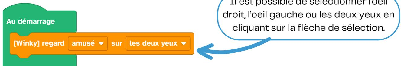
Il est possible de sélectionner l'oeil droit, l'oeil gauche ou les deux yeux en cliquant sur la flèche de sélection.
