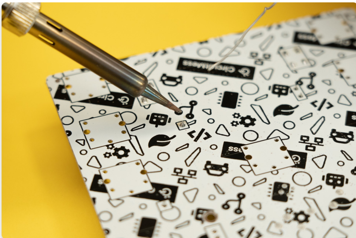
Soudure de la première broche
