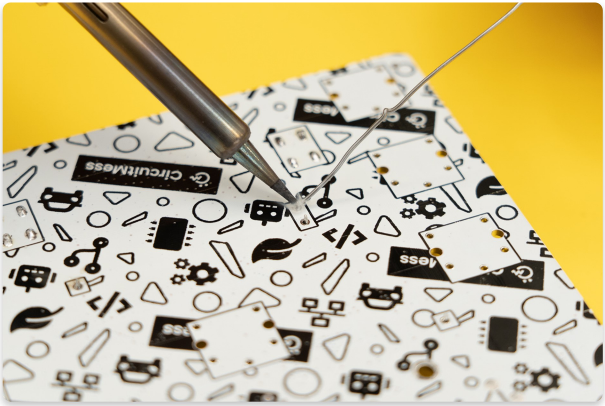
Soudure des deux broches
