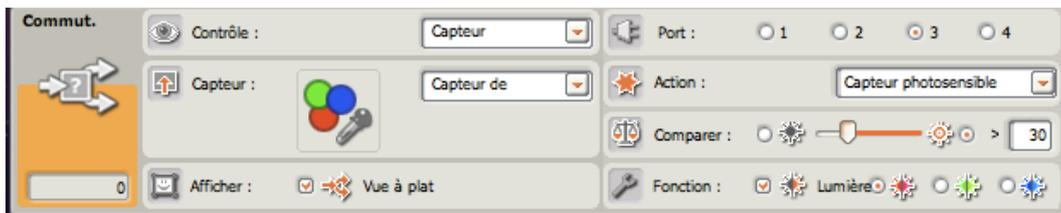
Dans une **Boucle** "Pour toujours", on trouve un Bloc **Commutateur** contrôlé par le **Capteur de Couleurs** en mode **Photosensible**. Le capteur mesure le niveau lumineux et le compare à une valeur seuil: ici fixée à 30.
