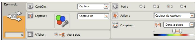
\* En mode ‘Capteur de couleurs’, Le bloc ne contient aucune petite icône significative. La commutation n’intervient qu’en fonction de la couleur choisie ( 6
