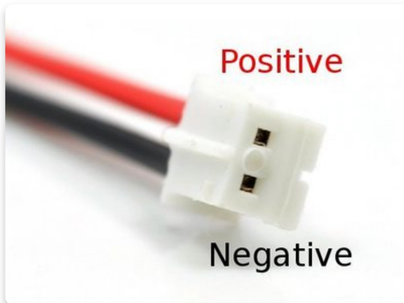
Câble JST qui relie la batterie
