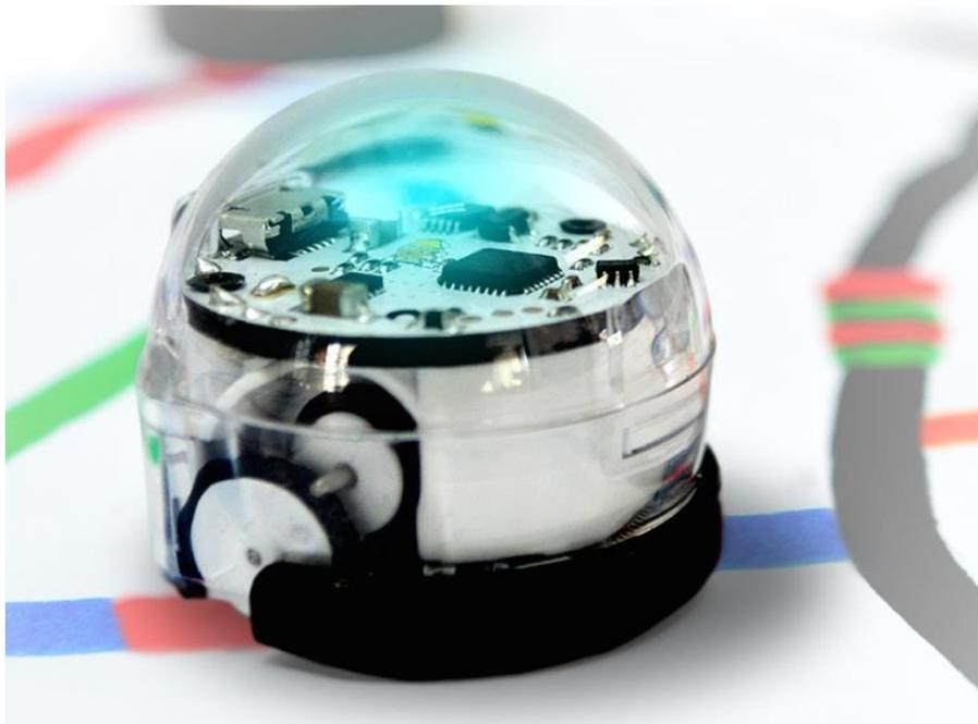
Dessinez une ligne noire de 6 mm de large, sur une feuille de papier blanche, mettez en route OZOBOT en pressant le bouton A/M sur le côté. Ensuite poser OZOBOT sur la ligne, ses capteurs vers l'avant.
